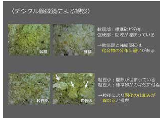
カキ殻を利用した土の固化処理の実験結果
